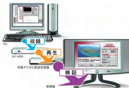
番組コンテンツの制作で最も重要な工程である受信機での動作検証。これを一般視聴者と同じ市販受信機で動作確認する検証ソフトウェア。また、制作した番組コンテンツをコンパクトなAV-HDD装置に収録できるため、デジタル放送受信機とリモコンを使ったデモが簡単にできる。オプションの変調器によりRF出力も可能で、リアルタイムな検証も可能。
