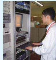
NHKアイテックのローコストなシステムを導入。写真は「データ放送送出装置」
